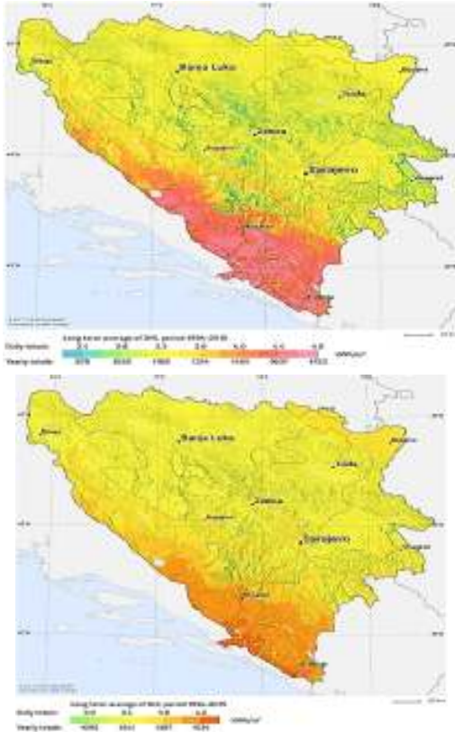
Slika 4. Prosječna vrijednost iradijacije za optimalno i horizontalno postavljene panele na području Bosne i Hercegovine, (Izvor: https://solargis.com/ )
