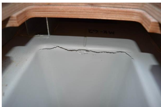
Slika 1. Oštećenje kobilice (Izvor: Autori 2018.)
