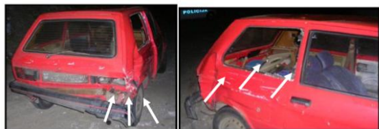
Slika 9. Oštećenja zadnjeg branika [3]
