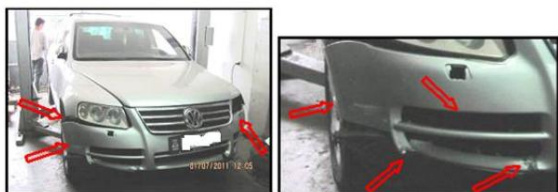
Slika 23. i Slika 24. Oštećenje prednjeg branika i „kidanje“ prednjeg branika [3]
